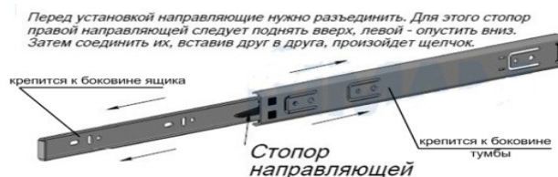
Рис.3 Схема установки шариковых направляющих
