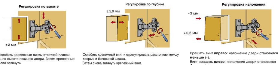
Слегка ослабить крепежные винты ответной планки, выверить по высоте позицию двери. Затем крепежные винты снова затянуть.
