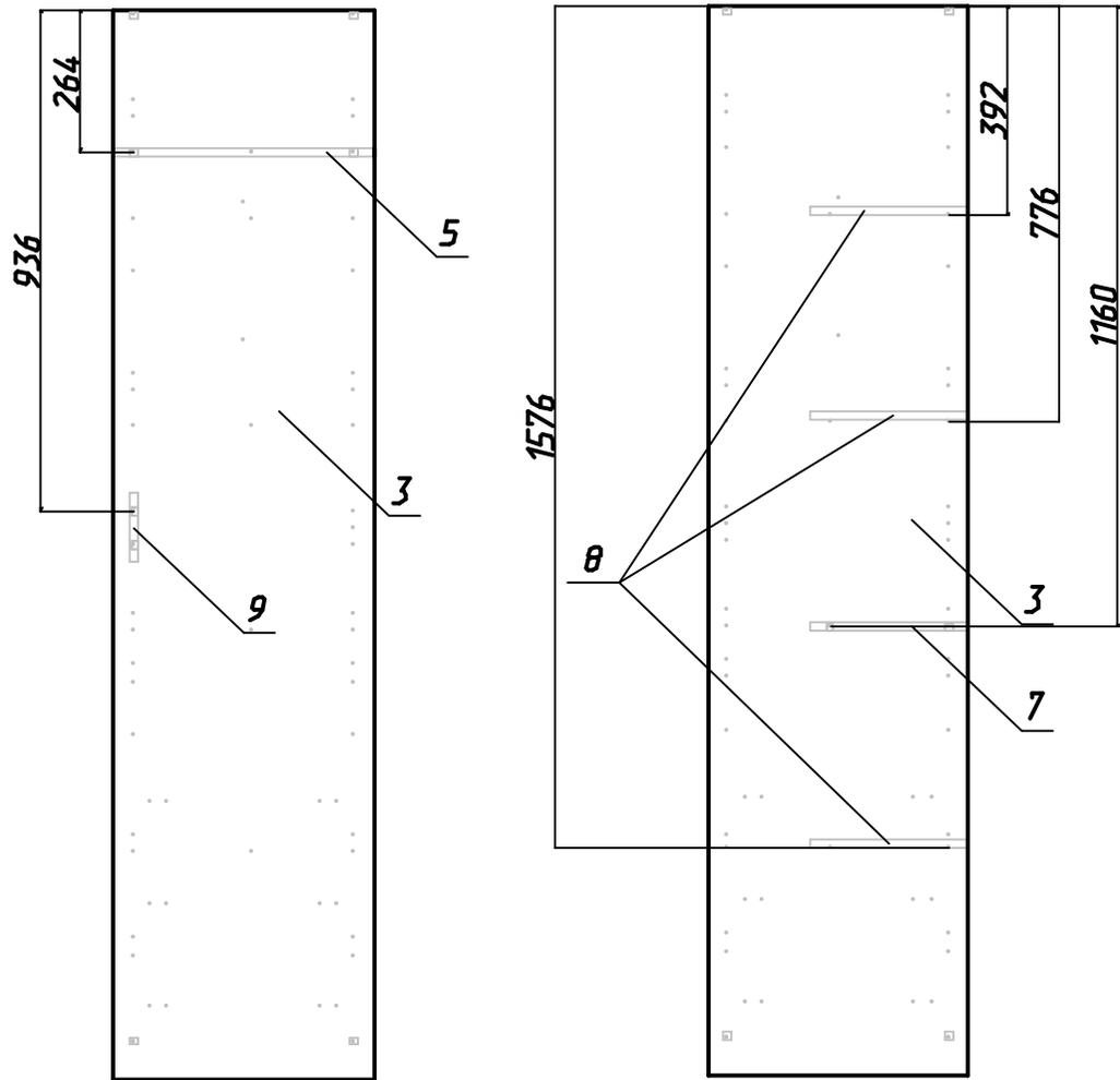
Рис.4 Схема установки деталей 5, 7, 8, 9
