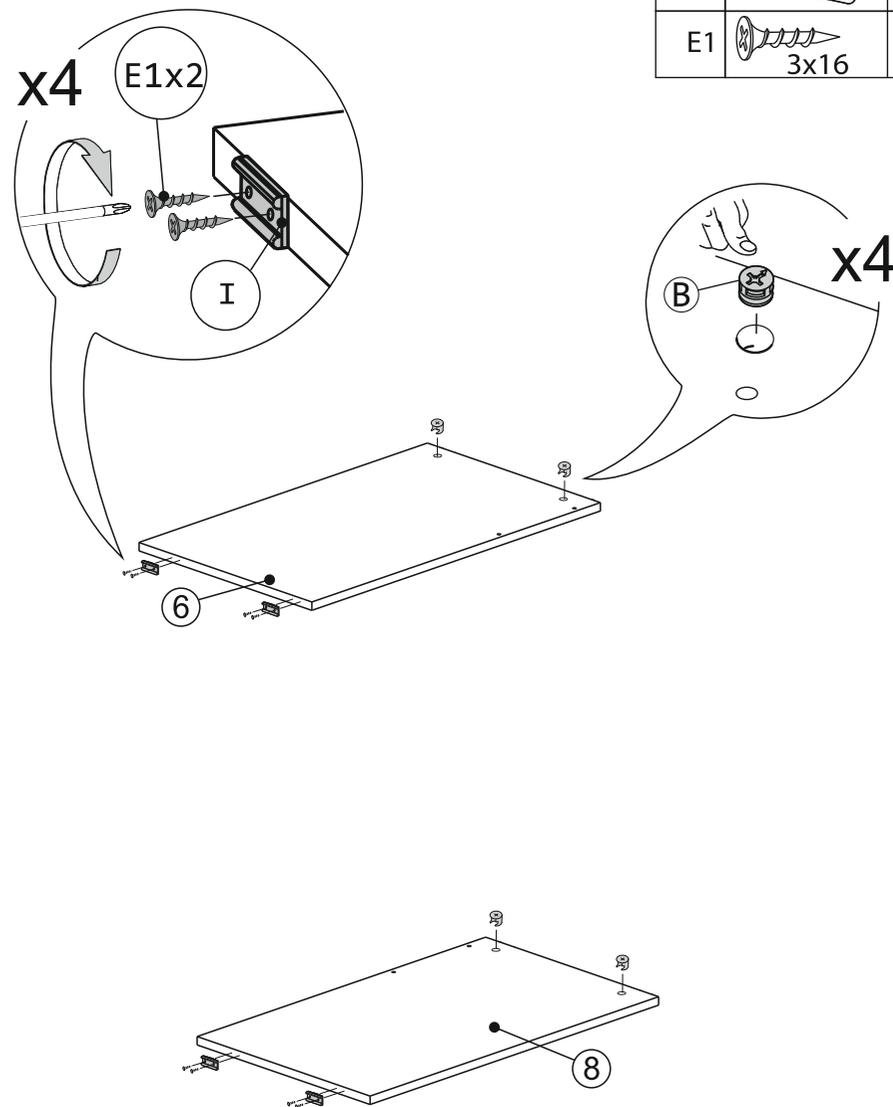
2. установите роликовые направляющие и фурнитуру (на одну из боковых и перегородку стола).
