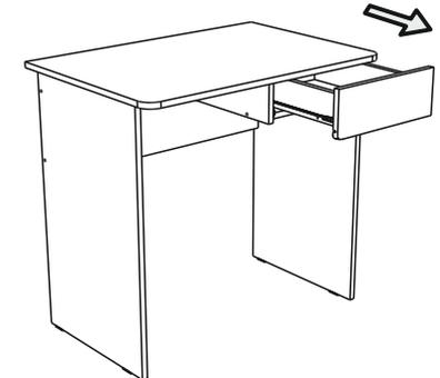
10. установите ответные части роликовых направляющих на ящик.
